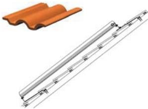
Para fijar los captadores en tejados con tejas planas
