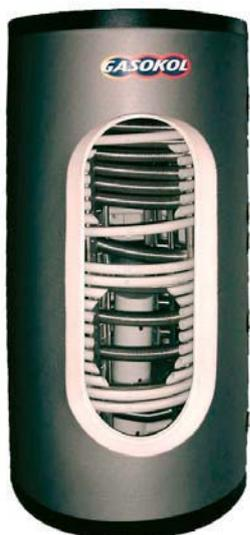
Acumulador combinado de estratificación con intercambiador para la producción de agua caliente sanitaria instantánea. Uno o dos intercambiadores tipo serpentín para el aprovechamiento de energía solar. Permite hasta tres niveles de temperatura para obtener al máxima eficiencia de la energía solar. Ideal para el apoyo a calefacción por suelo radiante con energía solar. El dispositivo estratificador de efecto térmico garantiza una estratificación excelente del retorno de la calefacción.
