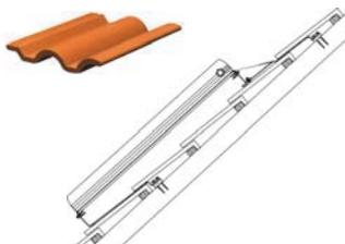
Para fijar los captadores sobre tejados con tejas planas
