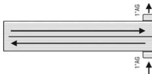
Diseño con poca pérdida de presión para instalaciones solares o separación de sistema. Acero inoxidable soldado, incl. aislamiento. presión de servicio máx. 30 bar, temperatura de servicio máx. 185 °C
