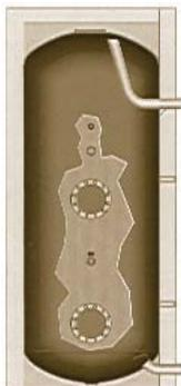
Los acumuladores universales están protegidos contra la corrosión mediante un esmaltado conforme a DIN 4753 y mediante un ánodo protector.
